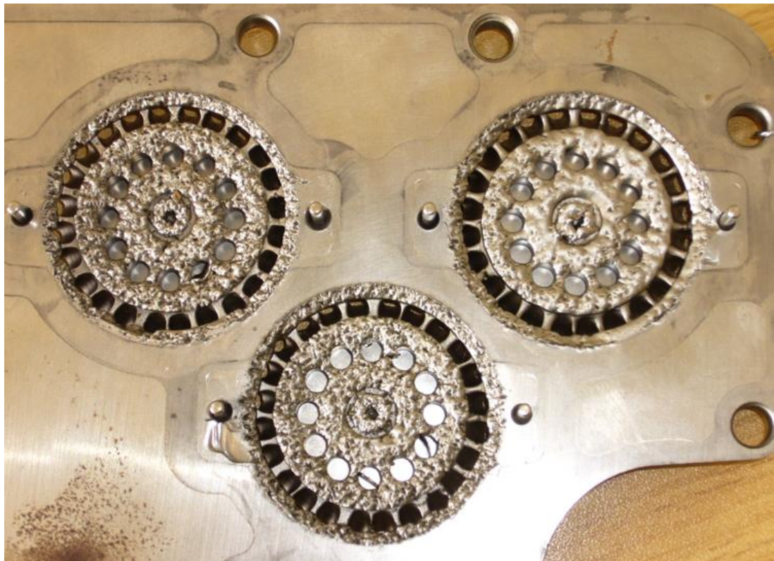
Doska ventilu trojfázových kompresorov typu TFH a TAG poškodená odieraním ocele alebo tvrdými nečistotami v okruhu.
