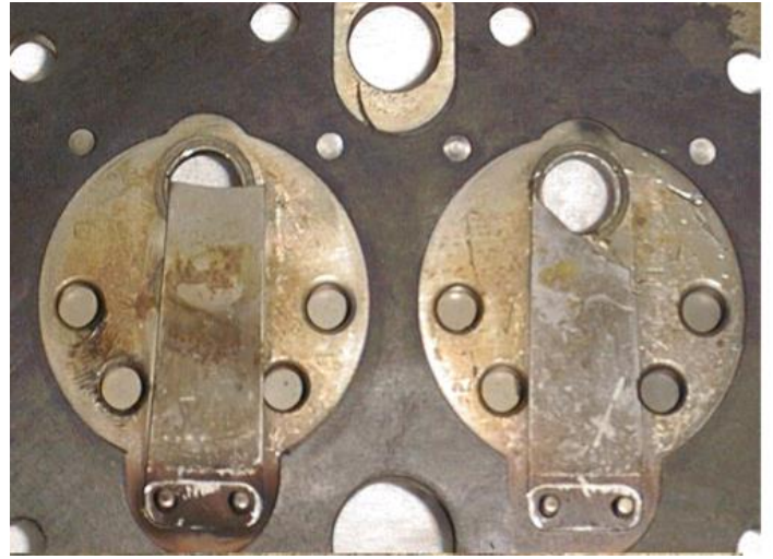
Kompresor nasával kvapalnú chladivo. Zlomené alebo inak poškodené ventily ventilovej dosky.
