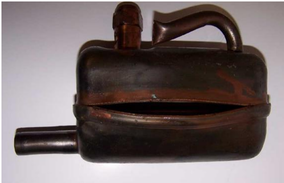
Tlmič na výtlaku kompresora praskol v dôsledku vysokého tlaku na výtlaku.
