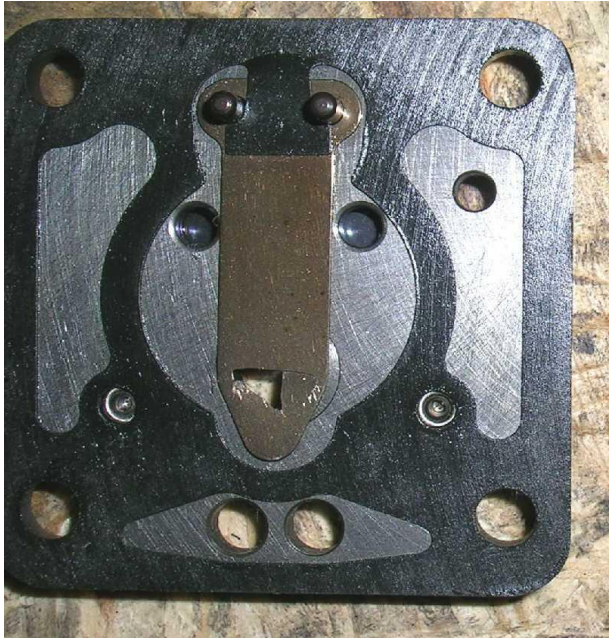
Kompresor nasával kvapalnú chladivo. Zlomené alebo inak poškodené ventily ventilovej dosky.
